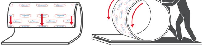
4- Formar la circunferencia de la lámina según su espesor con los siguientes diámetros para minimizar el riesgo de fracturas:
